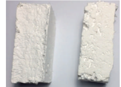
1. Plafones aislantes fabricados con residuos y CO 2 .
