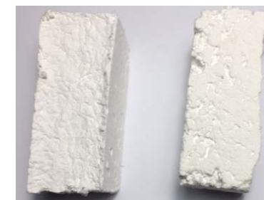
Imatge 1. Plafons aïllants fabricats amb residus i CO 2
