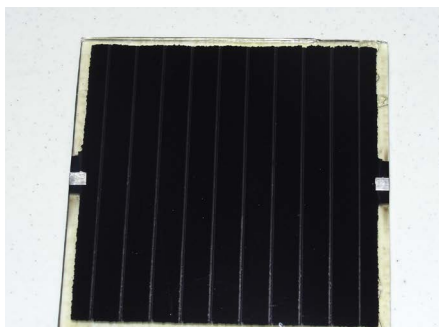
Imatge 2. Placa FV elaborada amb materials residuals vitrificats
