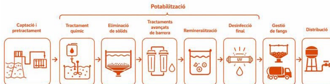
Figura 2. Diagrama dels processos i les etapes que es duen a terme en el tractament d'aigües. Font: Elaboració pròpia.
