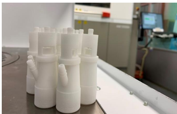
Vàlvules de venturi impreses en 3D (SLS) a la planta pilot del CIM UPC
