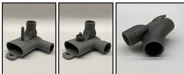
Tres dissenys de vàlvula de Charlotte desenvolupats i testejats a l'Hospital Sant Joan de Déu amb dues tecnologies de fabricació additiva: MJF de HP i SLA de 3DIGITALFACTORY
