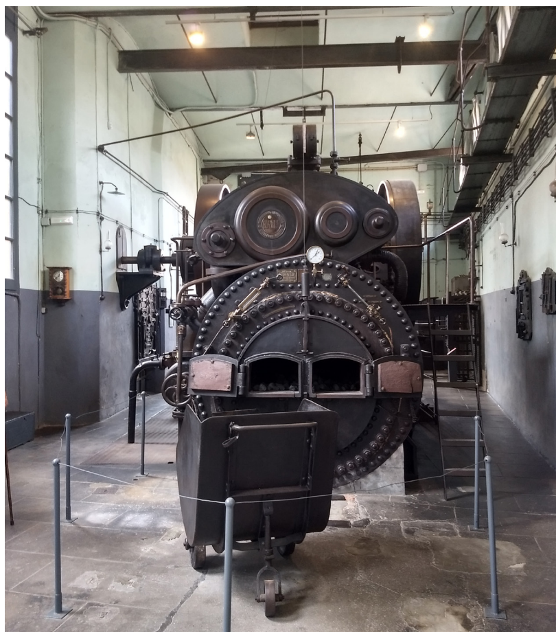
Fig. 17.- Màquina de vapor Wolf de 300 CV. Vapor Buxeda Vell. Jordi Izard
