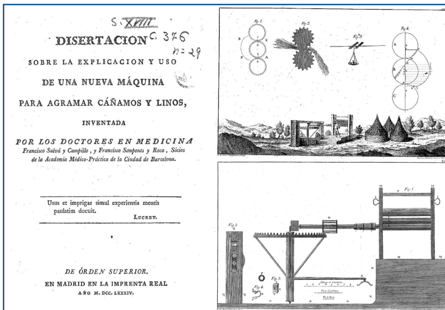
Fig. 4. Nova màquina per bregar cànem i llins, construïda per Francesc Salvà i Campillo i Francesc Santponç i Roca (1784)
