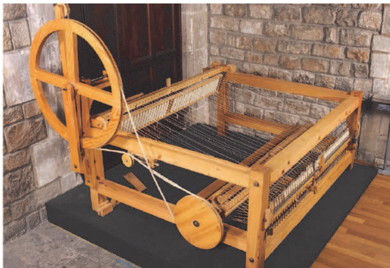
Fig. 1. Bergadana. Màquina de filar construïda a Berga per Ramon Farguell a finals del segle XVIII. Museu Nacional de la Ciència i la Tècnica de Catalunya (mNACTEC)
