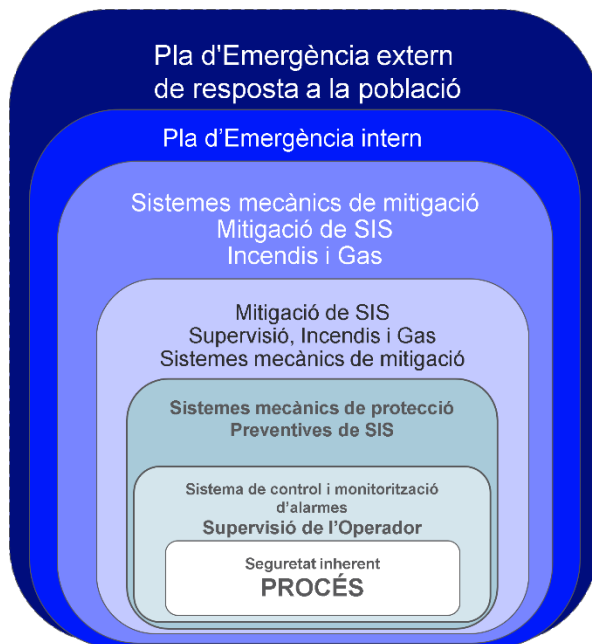
Figura 6.3. Diferents capes de protecció (IEC 61.511)
