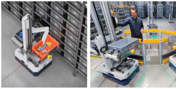
Figura 13: Brightpick AMR / Picking Robot amb illa de picking quan el robot no pot realitzar el pick, o l'AMR no porta robot.
