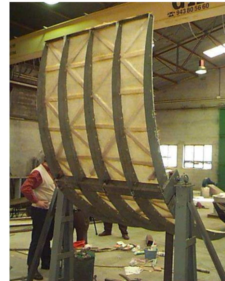
Prototipo de concentrador cilindro parabólico fabricado con composite
