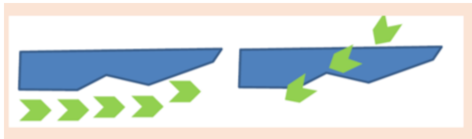
Imatge 4. Obra de fàbrica sota una carretera per al pas de fauna.
