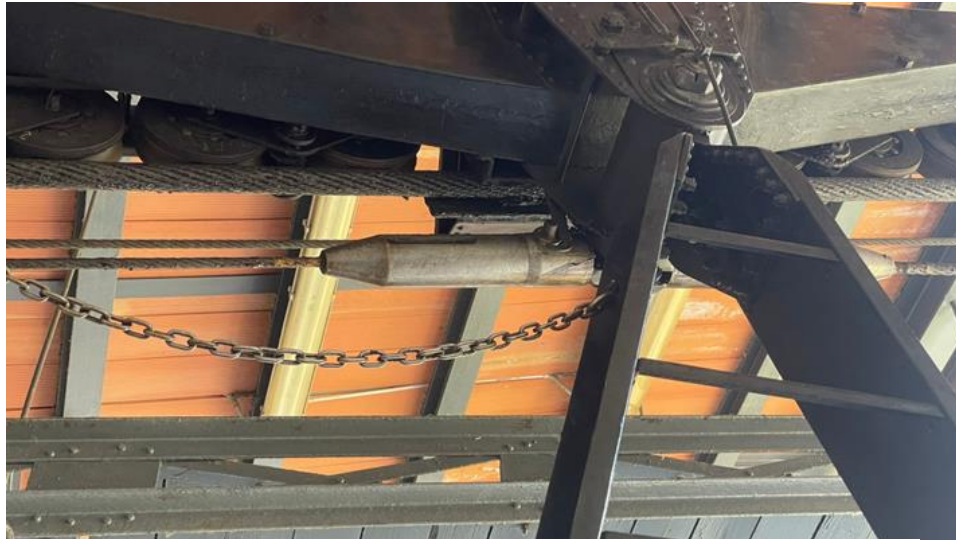
Representación esquemática del extremo del tractor conectado a la cabeza fundida que conectaba a la cabina núm. 3
