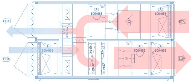
Se debe RECUPERAR el aire de Ventilación
