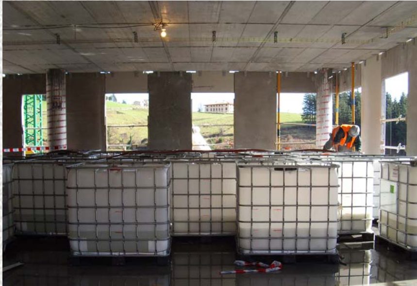
PLANTA PRIMERA: Deformaciones producidas por la Sobrecarga de 400 kg/m 2 en el vano objeto de estudio de la Prueba de Carga in situ
