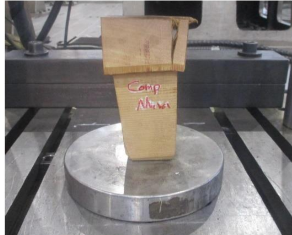
Imatge 5. Vista del trencament de la mostra per l'assaig de compressió de la dent nova.
