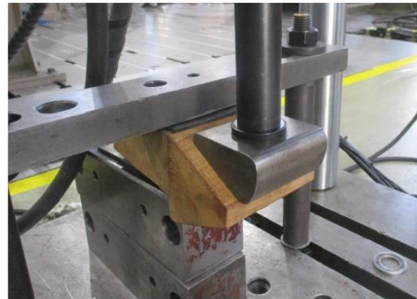
Imatge 6. Vista detallada de la configuració d'assaig (cisalla).
