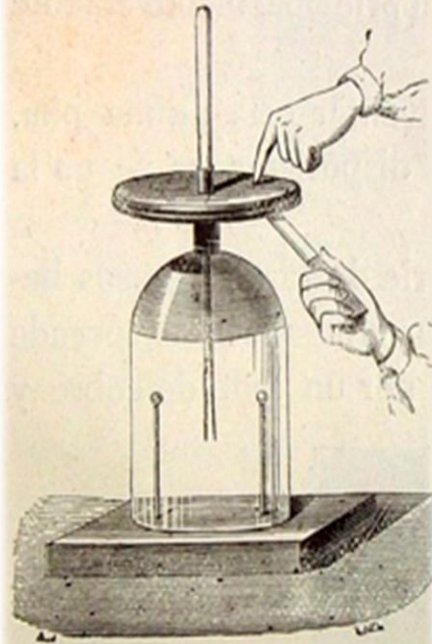
Fig. 110.—Condensador de Volta: experimento sobre la electricidad de contacto
