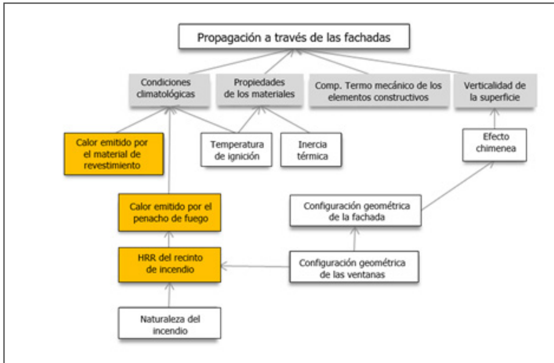
Figura 2.1. Esquema dels factors que incideixen en la propagació del foc a través de les façanes.
