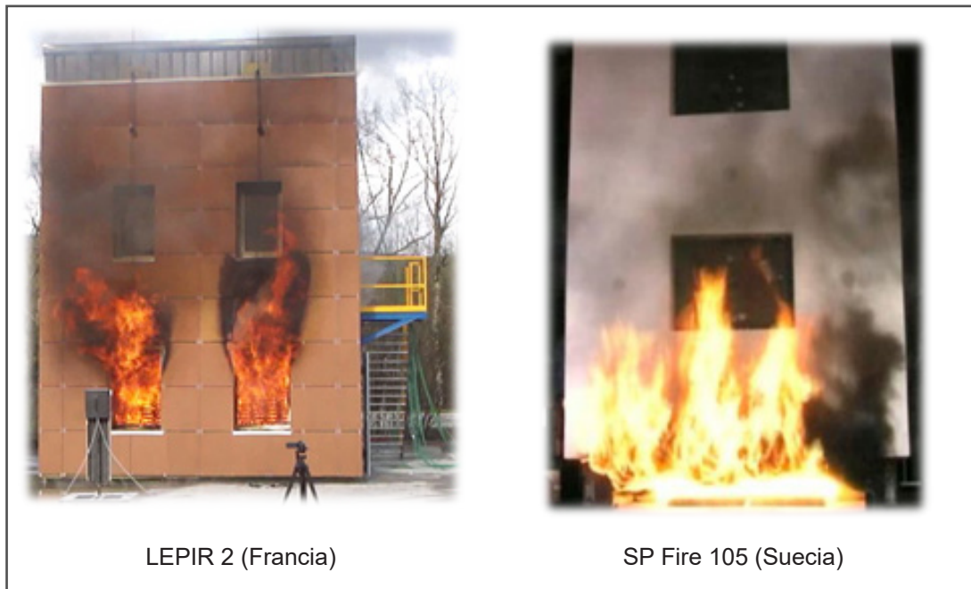
Figura 5.18. Ejemplos de métodos de ensayo a gran escala Fuente: LEPIR 2, SPFIRE 105
