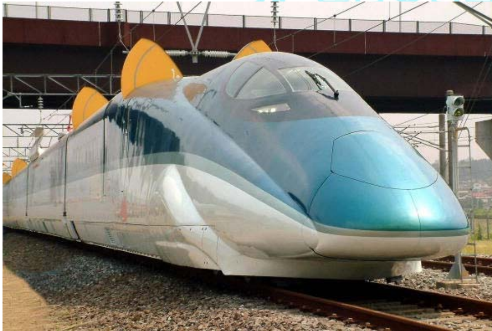
Frens aerodinàmics a un tren Shinkansen Fastech 360S
