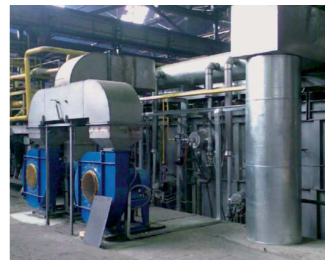
Figura 63 Forn d'escalfament de lingots de coure i llautó
