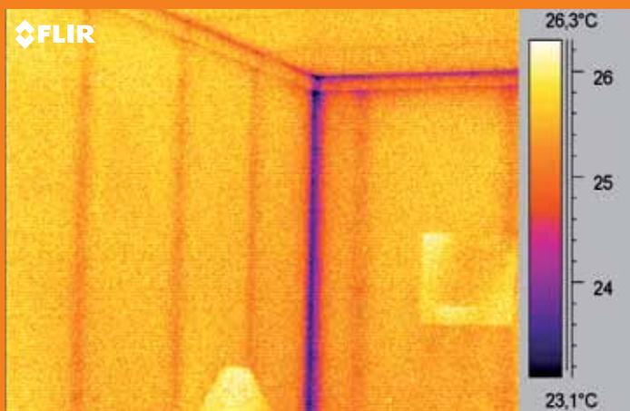
Imagem IR tomada desde el interior. La estructura es visible y también los tornillos que ajustan el panel que cubre la estructura. La esquina está claramente más caliente, lo que se llama efecto-esquina, pero no hay nada incorrecto allí.
