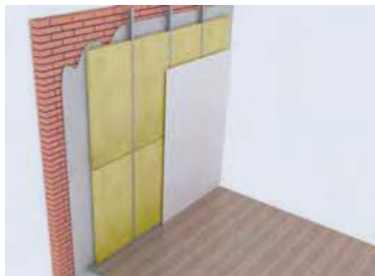
Figura 61. Aislamiento acústico en muro. Fuente: pladur-barcelona.es
