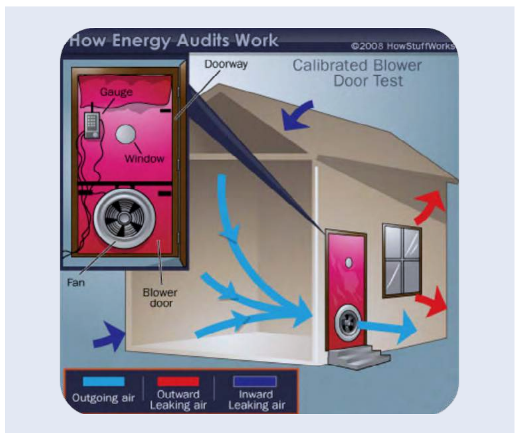
Figura 68. Esquema de Ensayo Blower Test. Fuente: lewisinsulation.com
