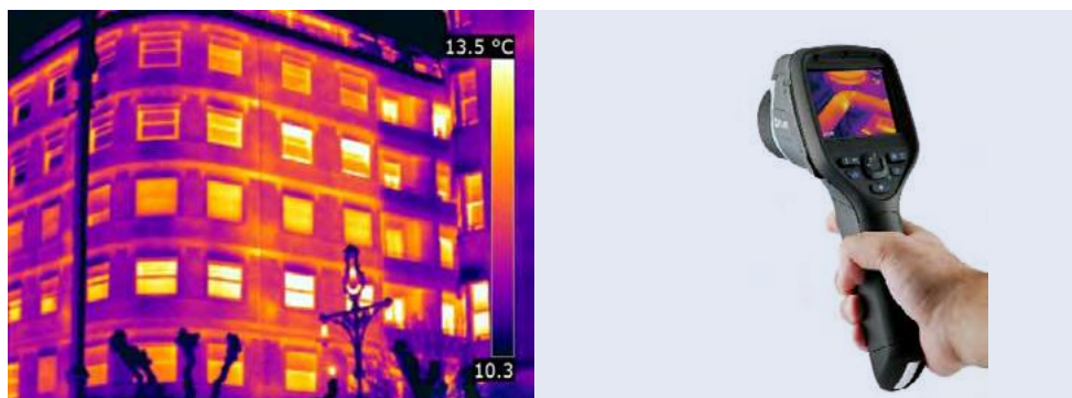
Figura 71. Termografía de un edificio. Elaboración propia.
