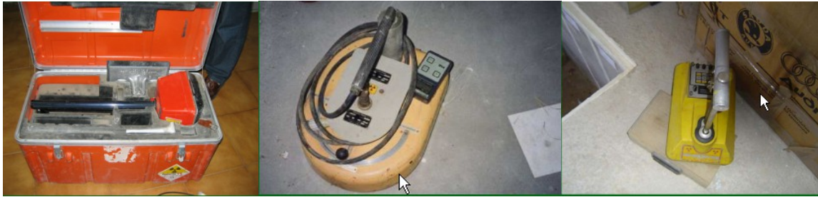
EQUIPOS DE MEDIDA DE DENSIDAD Y HUMEDAD DE SUELOS. • Radionucleidos habituales Cs-137 , Am-241/Be. • Actividades medias, Cs-137 370MBq (10mCi), Am-241/Be 1850MBq (50mCi)
