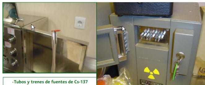
•FUENTES PARA TRATAMIENTO ONCOLÓGICO EN CONTACTO (BRAQUITERAPIA) •Radionucleidos habituales: Cs-137, Ir-192 •Actividades medias, entre 111MBq y 11,1 GBq (3 y 300mCi)
