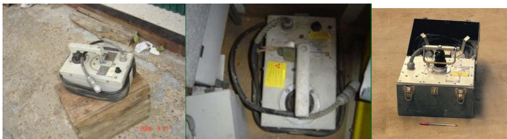
EQUIPOS DE MEDIDA DE DENSIDAD Y HUMEDAD DE SUELOS. • Radionucleido: Ra-226/Be. • Actividades medias, 185MBq (5 mCi)
