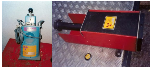
EQUIPOS DE MEDIDA DE DENSIDAD Y HUMEDAD DE SUELOS. • Radionucleidos habituales Cs-137 , Am-241/Be. • Actividades medias, Cs-137 370MBq (10mCi), Am-241/Be 1850MBq (50mCi)
