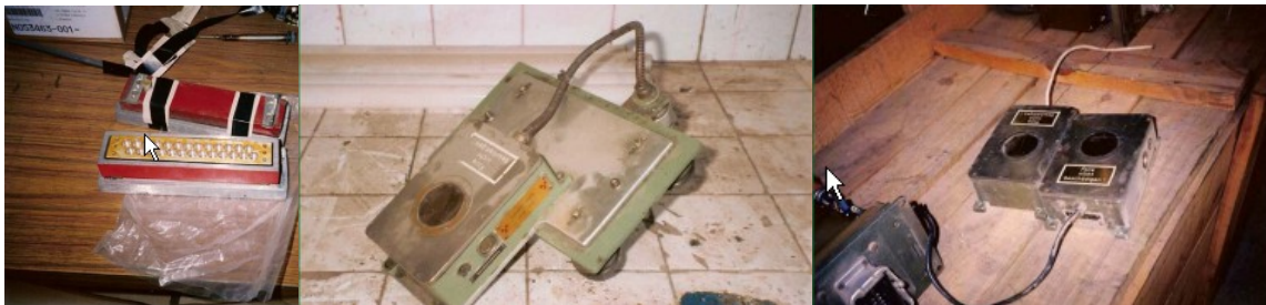
EQUIPOS DE MEDIDA DE CARACTERÍSTICAS DE MATERIALES: ESPESOR PLÁSTICO, PAPEL. • Radionucleidos habituales: Sr-90, Kr-85, Am-241, Pm- 147.
