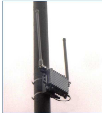
Detall: Equip de comunicacions WiFi Mesh de Motorola
